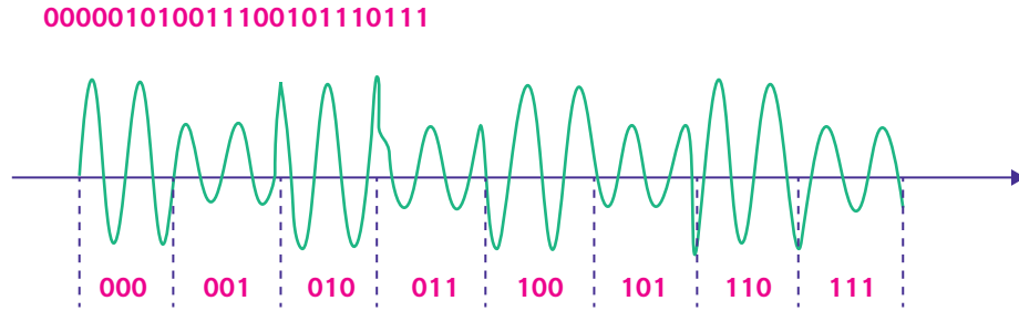
Figur 16.18 8 QAM transmisjon av en binær sekvens
