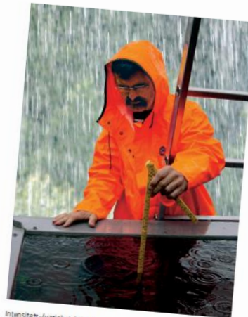
Intensitet-/varighetskurver for regn gir grunnlag for dimensjonering av taknedløp. Foto: SINTEF Byggforsk
